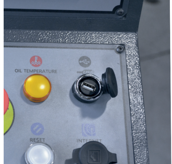
Ağ bağlantı ile Uzaktan destek ve bakım Remote assistance and maintainance with network
